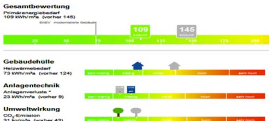
Bild 46 Verbesserung durch anbringen des Wärmeverbundsystems
