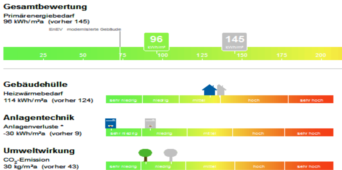
Bild 55 Verbesserung durch Änderungen der Anlagentechnik
